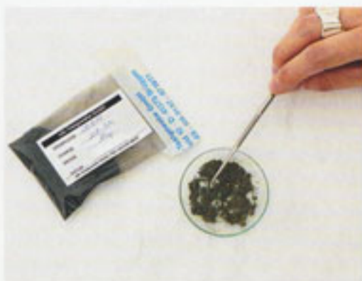
Industriell hergestellter Standardschmutz zur farblichen Anpassung an die vorhandene Patina. Links: Bohlmann arbeitet an der Beuys-Installation „Richtkräfte für eine neue Gesellschaft“ (1974)
